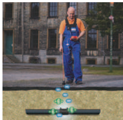
Figura 7. Detecção de fuga em conduta enterrada, através de gás traçador.
