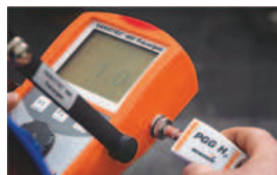
Figura 8. Representação da libertação do gás traçador numa fuga em conduta enterrada. Calibração de analisador.
