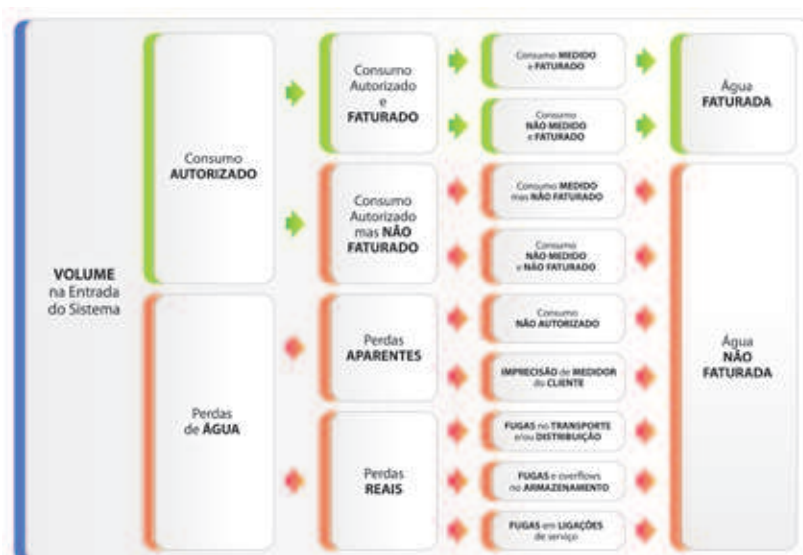
Figura 1. Método de avaliação de perdas – Modelo de cálculo padrão do IWA (International Water Association).
